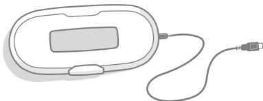
**Le câble USB fourni ne doit être utilisé que pour les mises à jour du micrologiciel. Il ne doit pas être utilisé pour recharger ni pour alimenter le lecteur.** Les mises à jour du micrologiciel seront affichées sur le site Web de HomeAgain dès qu'elles seront accessibles.
