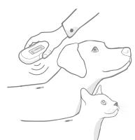
Appuyez à nouveau sur le bouton, le lecteur balaye pendant environ 12 secondes après avoir appuyé sur le bouton et maintenez-le en contact avec le corps de l'animal. Déplacez le lecteur LENTEMENT, en suivant les tracés de balayage recommandés ci-dessous.
