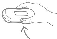
Legen Sie die Batterien wie auf Seite 20 beschrieben ein und drücken Sie die Taste am Sensor (wie dargestellt), um ihn einzuschalten. Bei Nichtgebrauch schaltet er sich automatisch aus.
